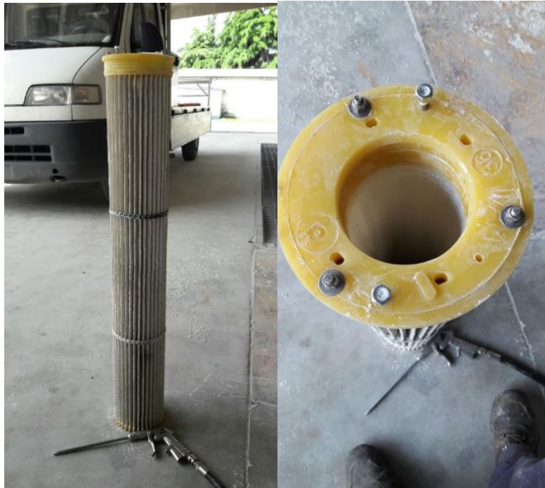
Foto 5: a sinistra i corpi filtranti della Wamm presenti all'interno del filtro Foto 6: a destra un particolare del corpo filtrante Wamm
